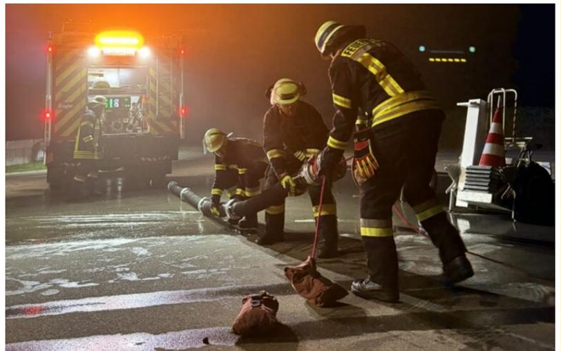
Saugschlauchkuppeln - Im Einsatz wird damit aus einem Gewässer Löschwasser angesaugt (Foto: Tratz)
