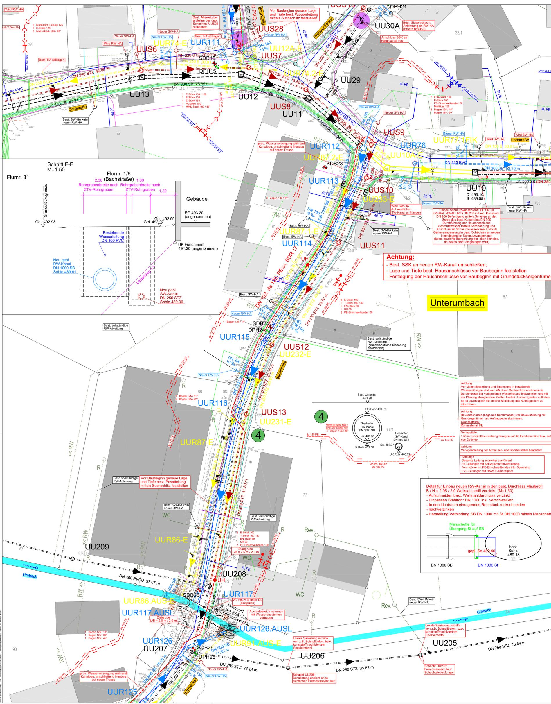
**Achtung:** Bei Erstellung der Hausanschlüsse auf strikte Trennung von Schmutz- und Regenwasser achten, Fehlschlüsse vermeiden.
